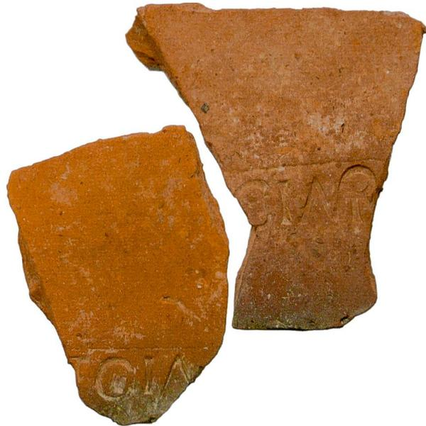
Abb. 39: Kaiseraugst AG, Liebrüti (Grabung 1974.011). Die tegulae Inv. 1974.10571 (links) und Inv. 1974.10573 aus dem Streufund-FK A05525 aus der Umgebung sind an einem Bruch verbrannt; sie dürften daher schon in zerbrochenem Zustand in Ofen ZK 50 verbaut worden sein.
