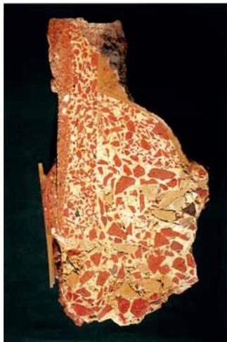
14 Ansicht einer geschliffenen Mörtelprobe (*opus signinum*) aus dem unteren Eckbereich der römischen Freispiegel-Leitung von Augusta Raurica.
